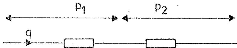
Fig. 1 - Seriekoppling av två strypningar.
