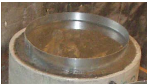
Figur 3.2.2 Delvis ingjuten plåtring för simulering av regn.
