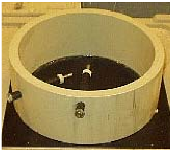
Figur 3.2.1 En av de 25 ringarna, som form för betongprovkropparna, med två mätrör för RF-mätning på olika djup.
