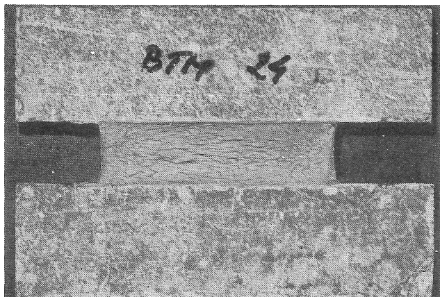
FIG 62 Provkropp av "Material 1" som utomhus-exponerats ca 7 månader.
