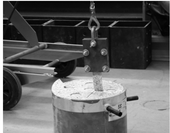
Figur 3.10 - Fläkningsprov på en 3 cm matta med hastigheten 10 cm/60 s [45].
