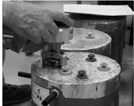
Figur 3.9 - Stålskiva med diametern 25 mm limmad till en utskuren mattdel vilken drogs loss i syfte att prova vidhäftningshållfastheten [44].
