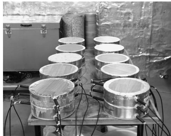
Figur 3.5 - Borrningen en vecka före montering av sensorn i plaströr och fuktmätningen.
