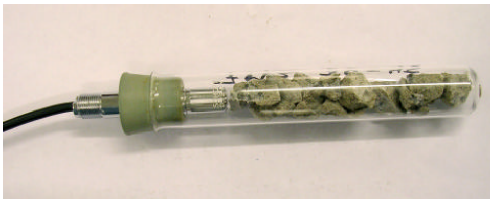
Figur 47. Provtagningsbitar i provrör samt Vaisala HMP 44 monterad i provrör för mätning.
