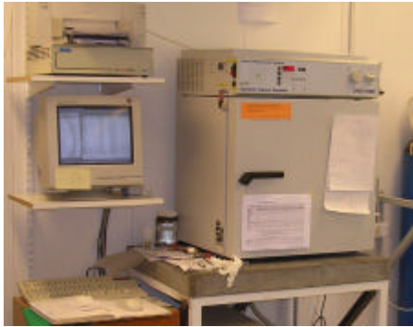
Figur 11. Sorptionsvåg DVS-1000 från tillverkaren Surface Measurement Systems. Principskiss av komponenter och flöden i DVS.
