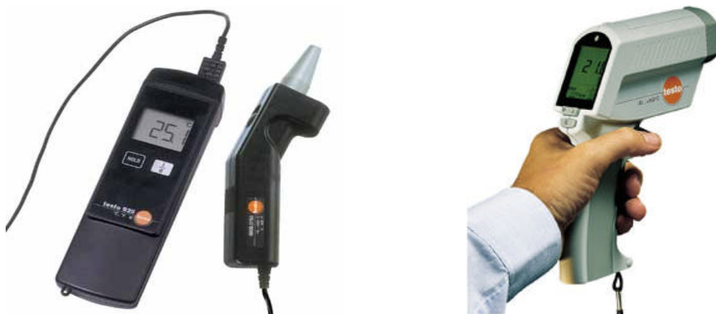
Figur 9. Testo 925/0602 samt en beröringsfri ytemperaturgivare med IR-teknik, samt Quicktemp 860-T2 (efterföljare till 850-1) IR-temperaturmätare med standardfokus
