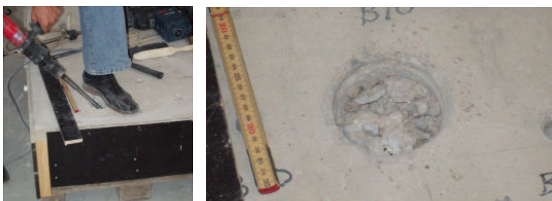
Figur 46. Uttagning av provtagningsbitar med kärnborr och bilningshammare.
