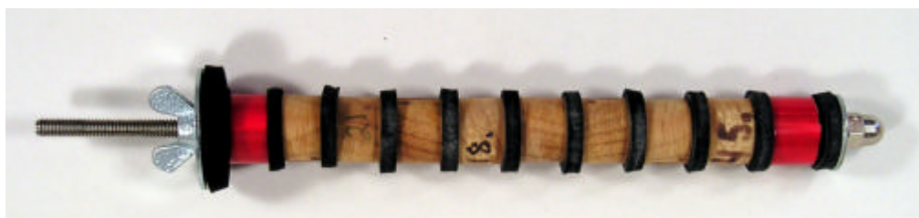
Figur 40. OE-stav som användes i försöket med två Temp-trissor och åtta RF-trissor.
