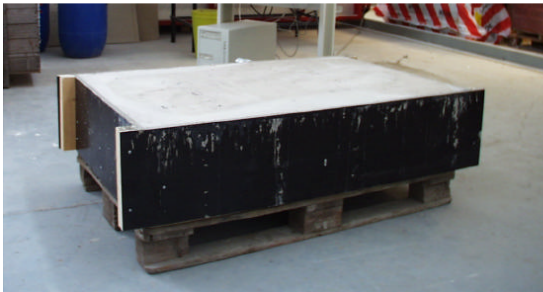
Figur 39. Provtagningsplattan med kvarsittande plywoodform.
