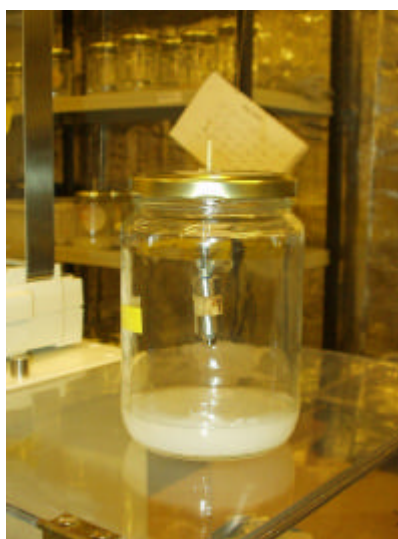
Figur 22. Klimatburk med RF-trissa monterad i upphängningsanordning. Schematisk skiss som visar undervägning med våg av en ”provkropp” i en klimatburk.
