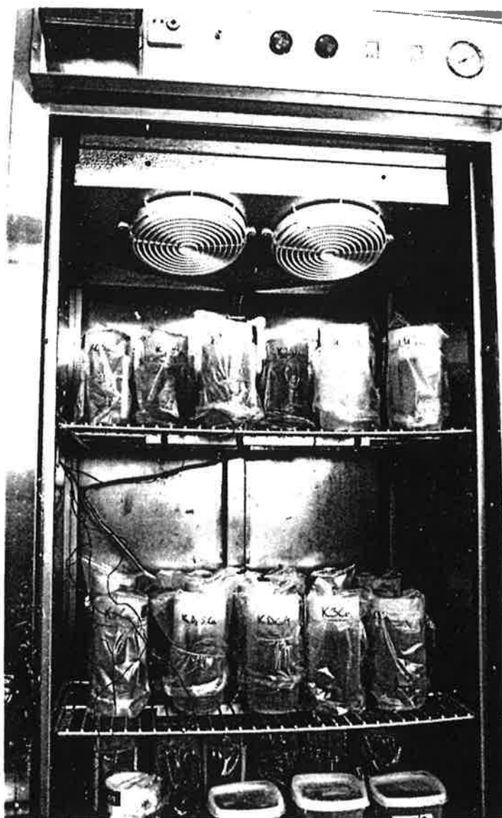
Figur 3.5. Avskalningsförsök. Bägare med prover placerade i frysskåp.
