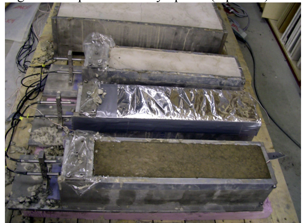
Figur 3.6 - Krympning 20-70 mm från ytan.
