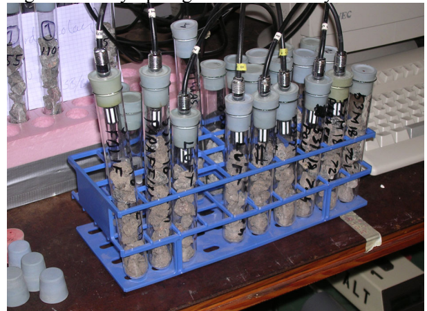
Figur 3.7 - Relativ fuktighet i betongfragment.
