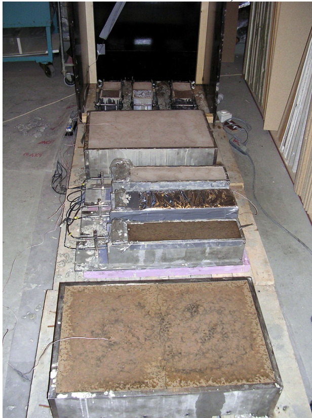
Figur 3.3 – Provkroppar i form av krympplattor, krympriggar och kuber.
