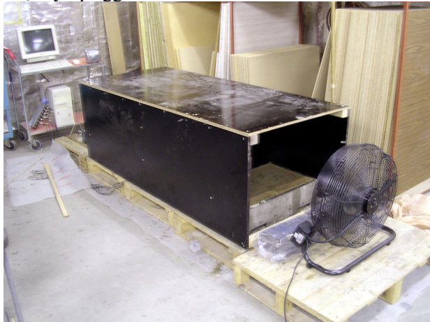
Figur 3.4 - Tunnel med lufthastighet 3.6 m/s.
