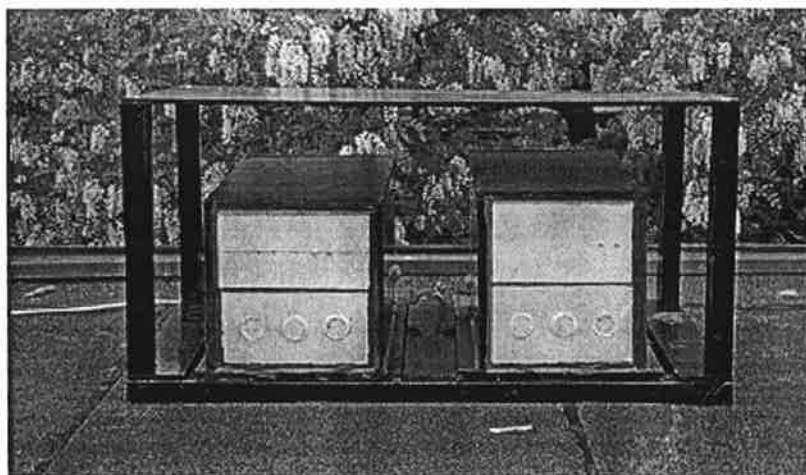
Figur 3. Foto på uppställning för mätning av fukt i utomhusexponerad naturstensfasad.
