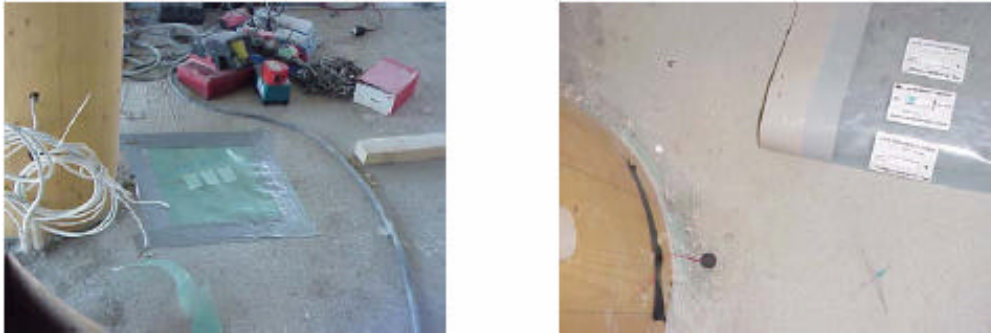
Figur 46 Placering av indikatorer på plastfolie som tejpas ned mot betongytan.
