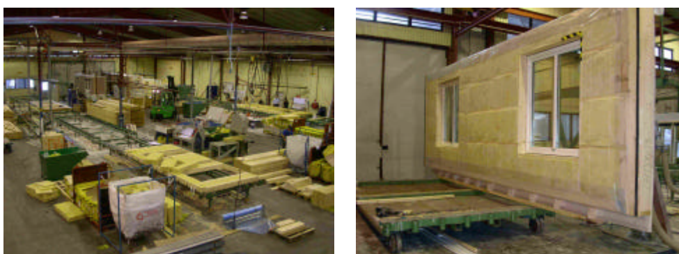
Figur 58 Tillverkningslina hos A-hus i Anneberg samt Väggelement med mätpunkt i fönstervinkeln vid gul-svart tejp.
