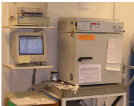
Figur 4. Sorptionsvåg DVS-1000 från tillverkaren Surface Measurement Systems. Principskiss av komponenter och flöden i DVS.
