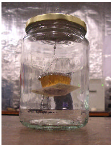
Figur 3. Klimatburk med indikator fastsatt på aluminiumform. Samt principskiss av provuppställning vid vägning under våg
