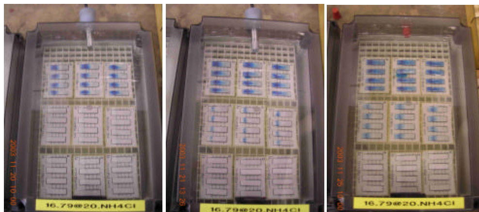
Figur 7. Exempel på utslag hos tre typer av indikatorerna vid 79 % RF. Bilderna är tagna efter 1, 2 respektive 6 dygns exponering.
