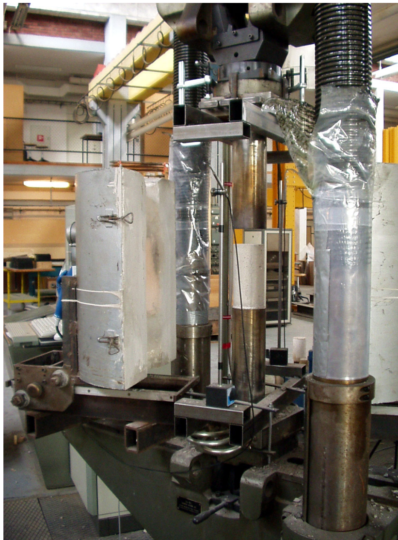
Figur 2.1 – Deformationer under konstant last 100-mm cylindrar med längd 200 mm. Foto: Stefan Backe.
