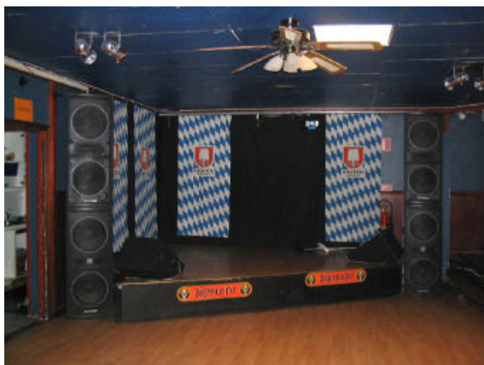
Bild 1. Scenen på Henriksbergs takterrass före ombyggnaden. Scenen är mycket liten och publiken hamnar mycket nära scenutrustningen och PA-högtalarna. Endast tunna textilier på scenväggarna och övermålade absorbenter i taket.
