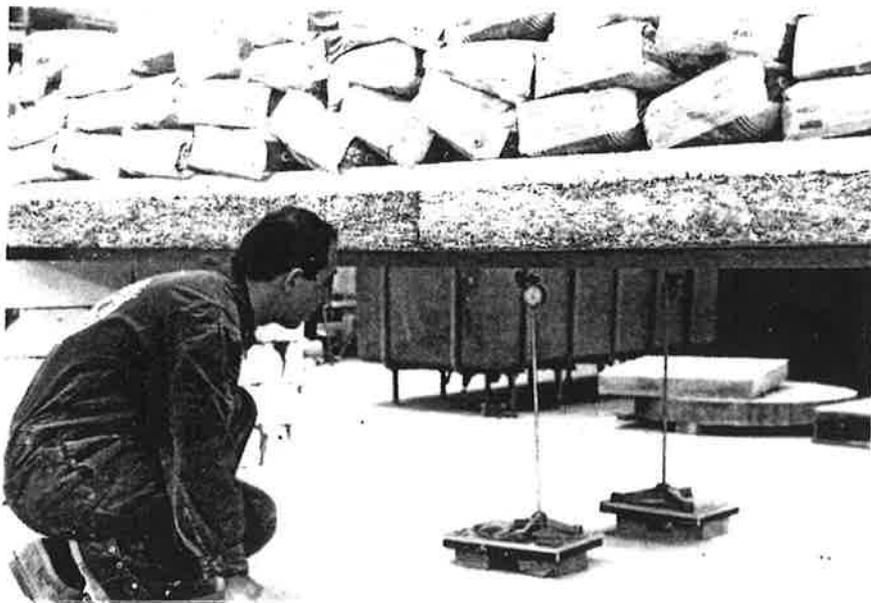
Figure 4.2.5. Mesures de la flexion de toiture 1 sous chargement.
