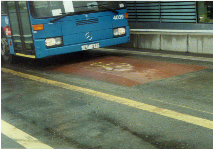
Figur 6.1 En stadsbuss provkör över en prototypvägkudde i testbanan i Bromma flygplats i Stockholm.
