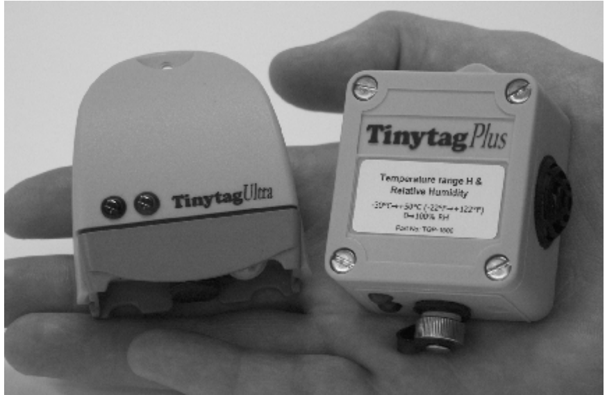
Fig. 3.12 Tinytag Ultra (à gauche) utilisé pour les mesures à l'intérieur du bâtiment (dimension : 8 × 8 cm) et Tinytag Plus (à droite) utilisé pour les mesures à l'extérieur (dimension : 8 × 8 cm)
