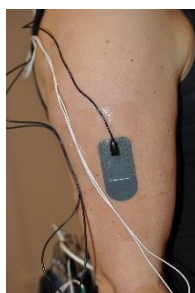
Figur 3. Inclinometer på höger överarm som mäter arbetsställningar och rörelser i armen.
