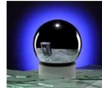
Avogadroexperimentets anrikade kisel-28-klot. I dess yta speglar sig en kopia av kilogram-prototypen.
