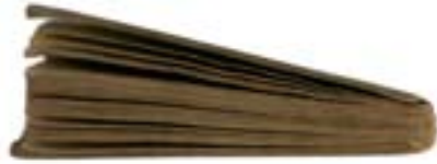
BILD III:8. Helansatt hårt pappersband (kartonnage), gult snitt. I bandets övre kant ser man att bandet är jämskuret i övre och nedre kant efter att pärm och överdrag anbringats på inlagan. Tekniken kallas helansättning. Inlaga jfr bild III:7.
