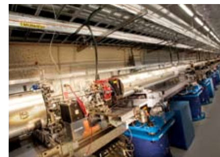
Den 120 meter långa undulatorn vid LCLS.
