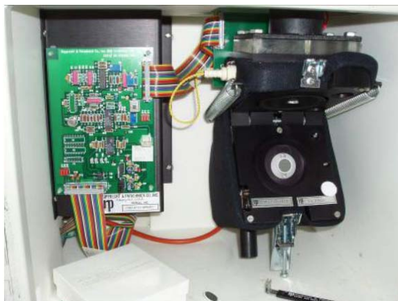
Figur 5. En illustration av filterboxen i TEOM-instrumentet, där filtret är monterat på glasstaven (Från Nilsson m. fl., 2009). Filtret är grånat efter en tids partikeluppsamling.
