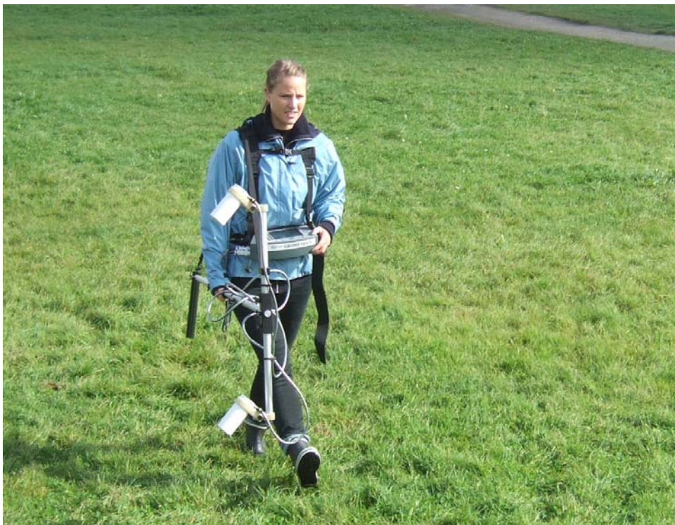
Figur 6. Mätning med magnetisk gradiometer.
