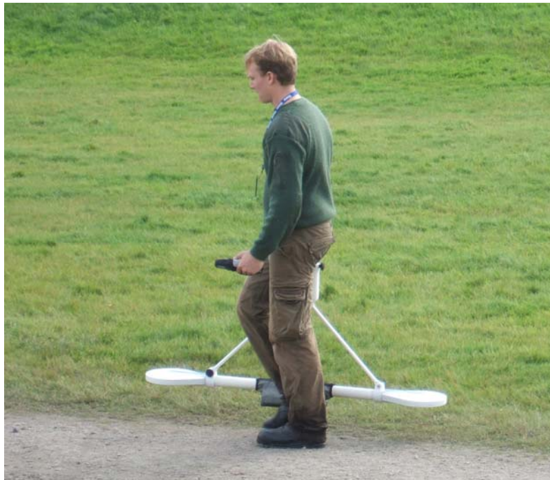
Figur 7. Mätning med stångslingram.
