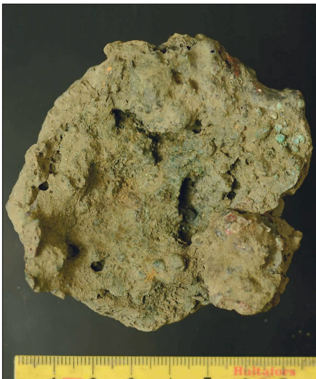
Fig. 1. Sekundärsmidesskälla med synliga koppardroppar. Från hantverksmiljön vid Motala Ström, Östergötland. Foto: A. Svensson, Faber Arkeologi. Slag cake from smithing with visible copper droplets. From Motala, Östergötland. Photo by A. Svensson, Faber Arkeologi.
