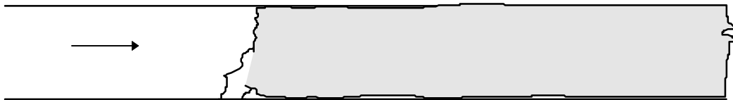
Figur B3.1 Principiell bild över hur det antas att brandgaserna blandas upp fullständigt nedströms branden.
