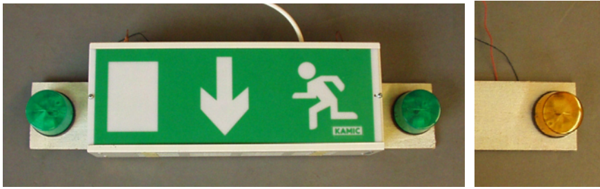
Figur 4.1 Genomlyst utrymningsskylt med kompletterande blyxtljus.
