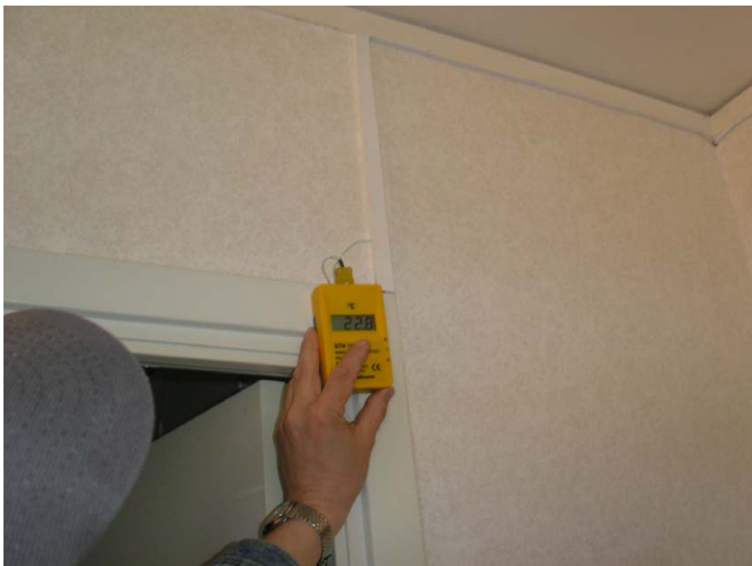
Bild 4.1 Längst ner i den vita listen från skugglist till karmfoder finns en sensor. Här utförs kontrollmätning. För att se så adressen i databasen går till rätt sensor.
