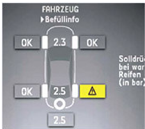
Figur 16. Däckluftrycks kontroll övervakning från fordonets instrumentpanel.
