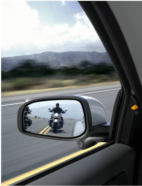
Figur 11. Dödvinkelassistent med varningslampa för att uppmärksamma föraren på, i detta fall, mc-fordon snett bakom. Källa: Volvo, http://www.volvocars.com .
