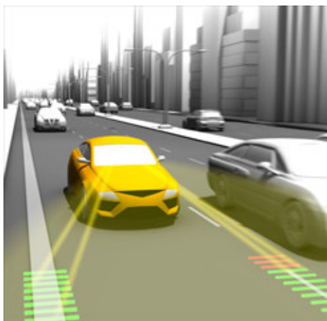
Figur 9. Sensorer för körfältsstöd håller koll på körfältsmarkeringarna Källa: Continental Automotive, http://www.conti-online.com .
