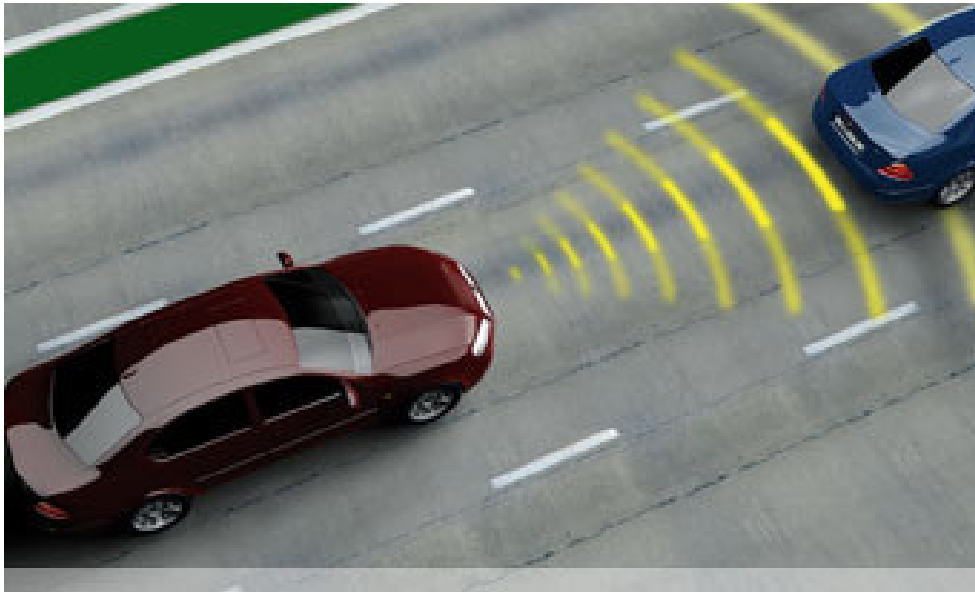
Figur 7. Funktionen Adaptiv farthållare (ACC) använder olika typer av sensorer beroende på tillverkare, monterade i bilens front, t.ex. radar eller laser som detekterar framförvarande fordon för att anpassa hastighet och avstånd.
