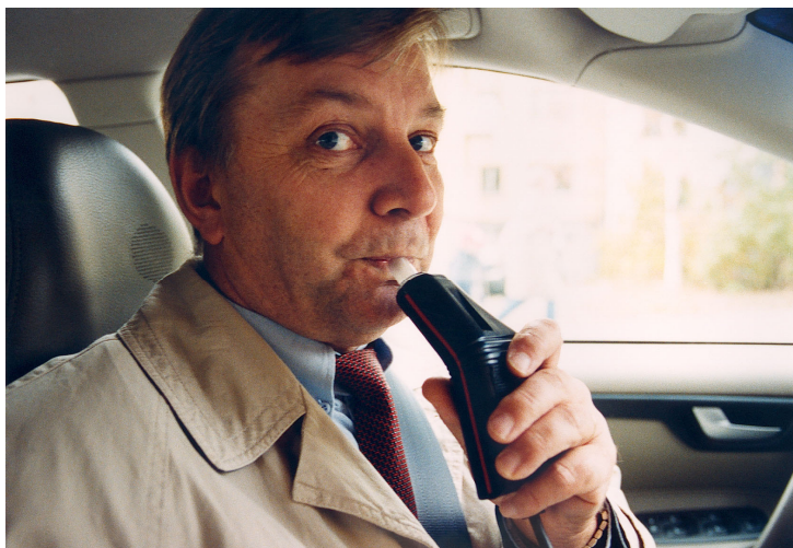
Figur 2. Alkolås för utandningskontroll före start av fordonet. Källa: MHF Pressrum. Foto: Carl Johan Erikson.
