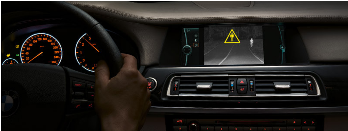
Figur17. Illustration av display på instrumentpanelen med mörkerkörningsassistent. Källa BMW, http://www.bmw.com .
