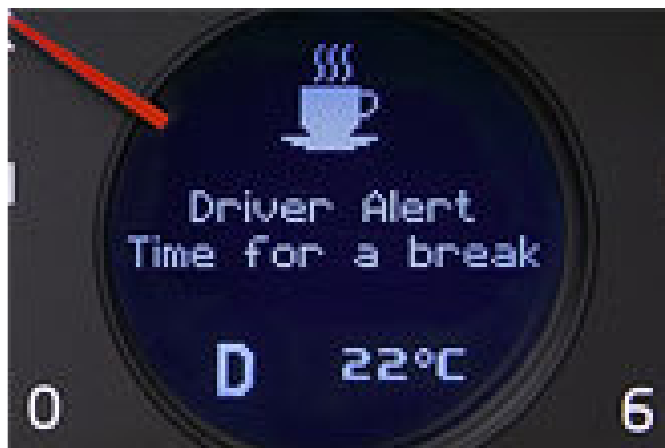
Figur 13. Aktiverad uppmaning på instrumentpanelen till föraren att ta paus.
