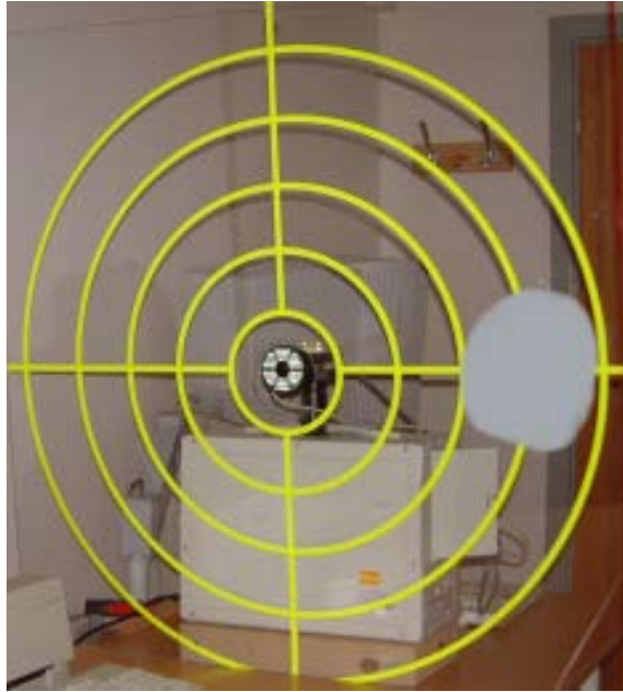
Figur 13. Fixations-ringarna på en plexiglasplatta är monterade i 5° vinkel ut till 25°, här runt kameran på PowerRefraktorn. Personen med centralt synbortfall ser sitt skotom, här simulerat med den grå fläcken vid riktningen 20° åt höger.
