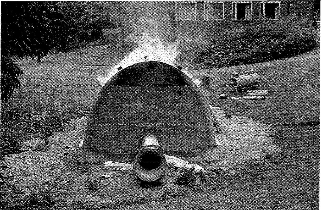
Fig. 4. För brandförloppsstudier vid KTH-s institution för konstruktionslära uppfört brandrum.
