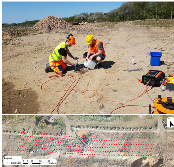
Figur 1: Insamling av DCIP-data i Dalby stenbrott. Notera kablaget med elektroderna samt instrumentet (till höger i bild). Ibland är det svårt att få tillräcklig kontakt mellan elektroder och mark, då krävs (som här) att vätska, eventuellt med tillsatser, hälls på marken runt elektroderna. Den undre delbilden visar elektrodernas inmätta positioner på markytan inlagda i ett ortofoto.
