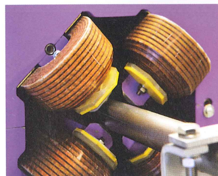
En kvadrupolmagnet längs linjäracceleratorn i MAX IV. Foto: Johan Persson.
