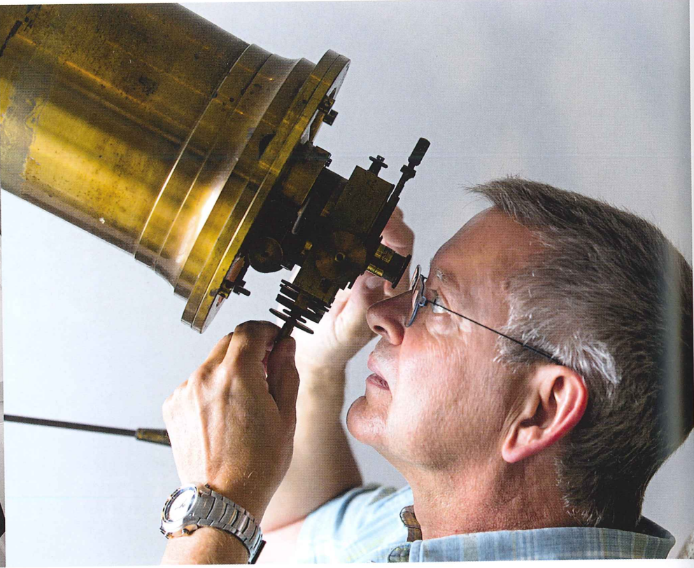
Lennart Lindegren provar en meridiancirkel, som man använde för att mäta stjärnornas positioner med på 1800-talet. FOTO: GUNNAR MENANDER
