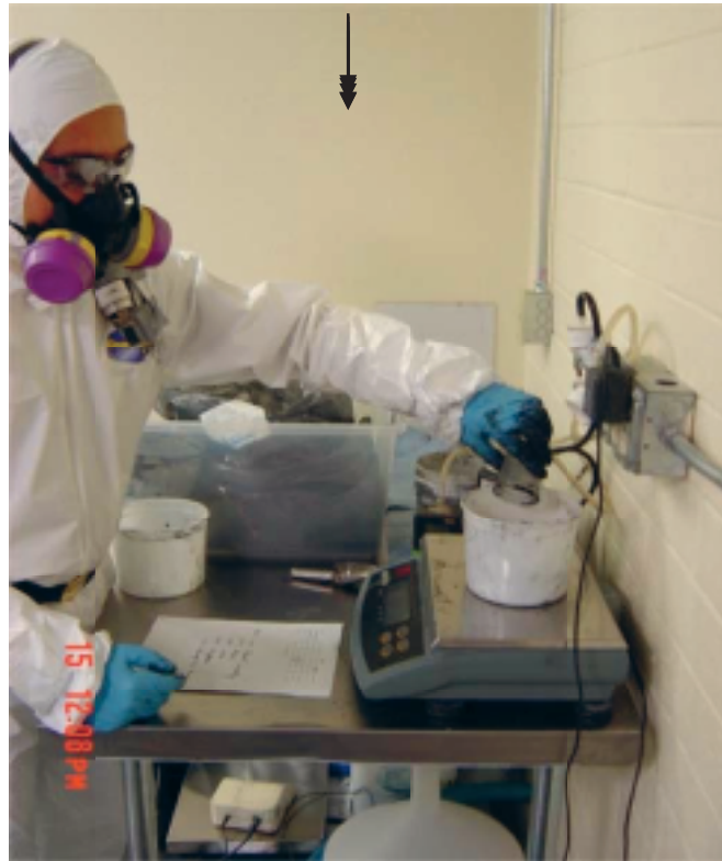
Figur 5. Vägning av MWCNT (med tillstånd av PA Schulte, NIOSH)
