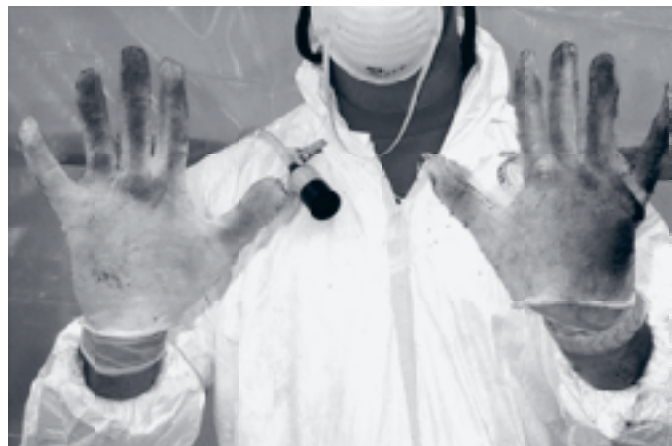
Figur 6. Skyddshandskar kontaminerade med mycket fint kolnanorördamm (med tillstånd av A Maynard, NIOSH; Baron et al., 2003)
