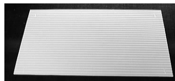
Figur 4. Panel från utflytningsförsök. Bra utflytning ger en jämn yta medan dålig utflytning ger en yta med tydliga linjer efter penseldrag.
