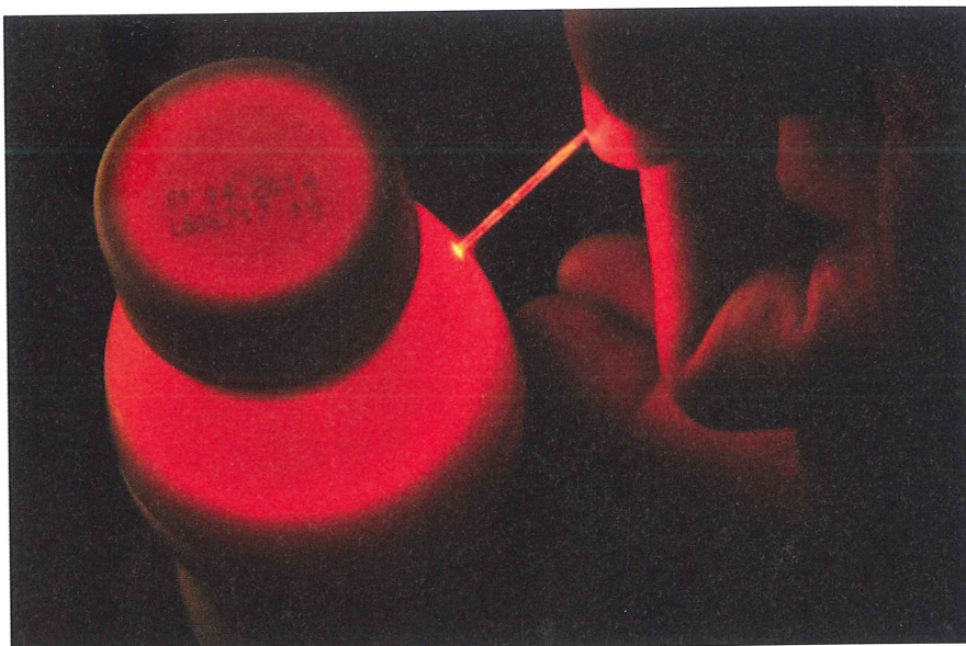
4. Rött ljus skickas med hjälp av en optisk fiber in i en dryckesförpackning av vit plast. Ljuset blir snabbt diffust vilket gör att sträckan ljuset går inuti förpackningen blir mycket svår att veta. Då krävs speciella knep för att kunna använda sig av absorptionsspektroskopi för kvantitativa gasanalyser.
