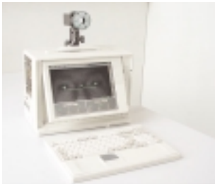
PowerRefraktorn är en bärbar dator med ett sex-armat retinoskop som mäter ögats refraktion (brytningsfel) på båda ögonen samtidigt.
