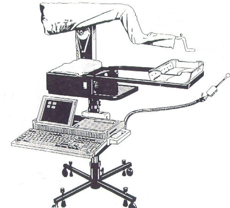
Bild 5. Den principiella uppbyggnaden av Handy 1.
