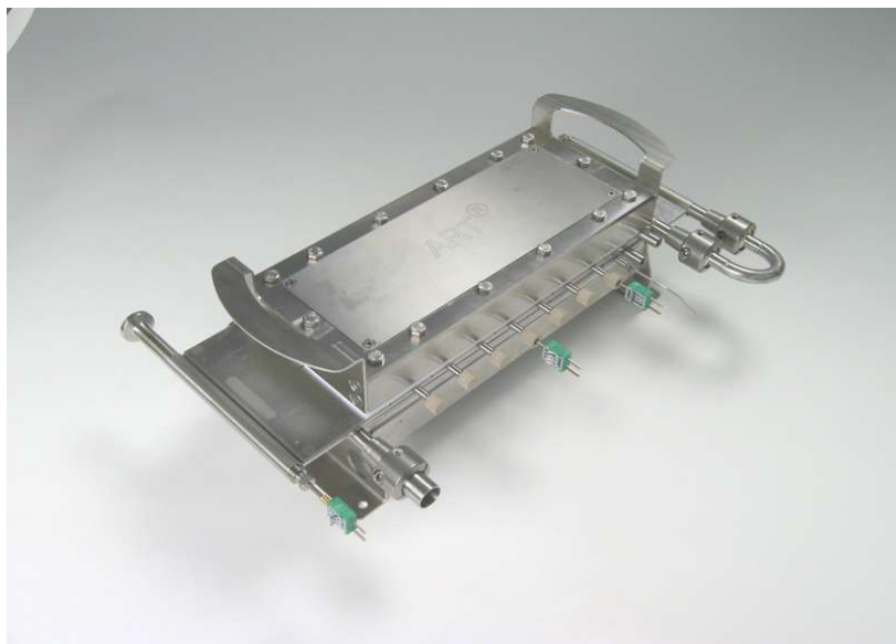
Figur 3: Bilden visar en plattreaktor i mindre skala som används i demonstrationssyfte och för att göra preliminära studier av företagens kemiska reaktioner. Copyright: Alfa Laval Corporate AB
