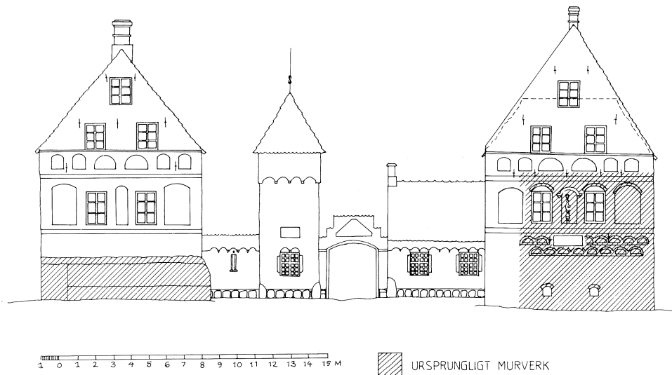
Fig. I: 3. Murverksanalys av södra fasaden. Sölve Johansson 1988. Skala 1: 300.
