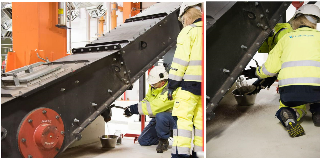
Figur B7. Uttapning av bottenaska ner i ett metallkärl för avkylning.
