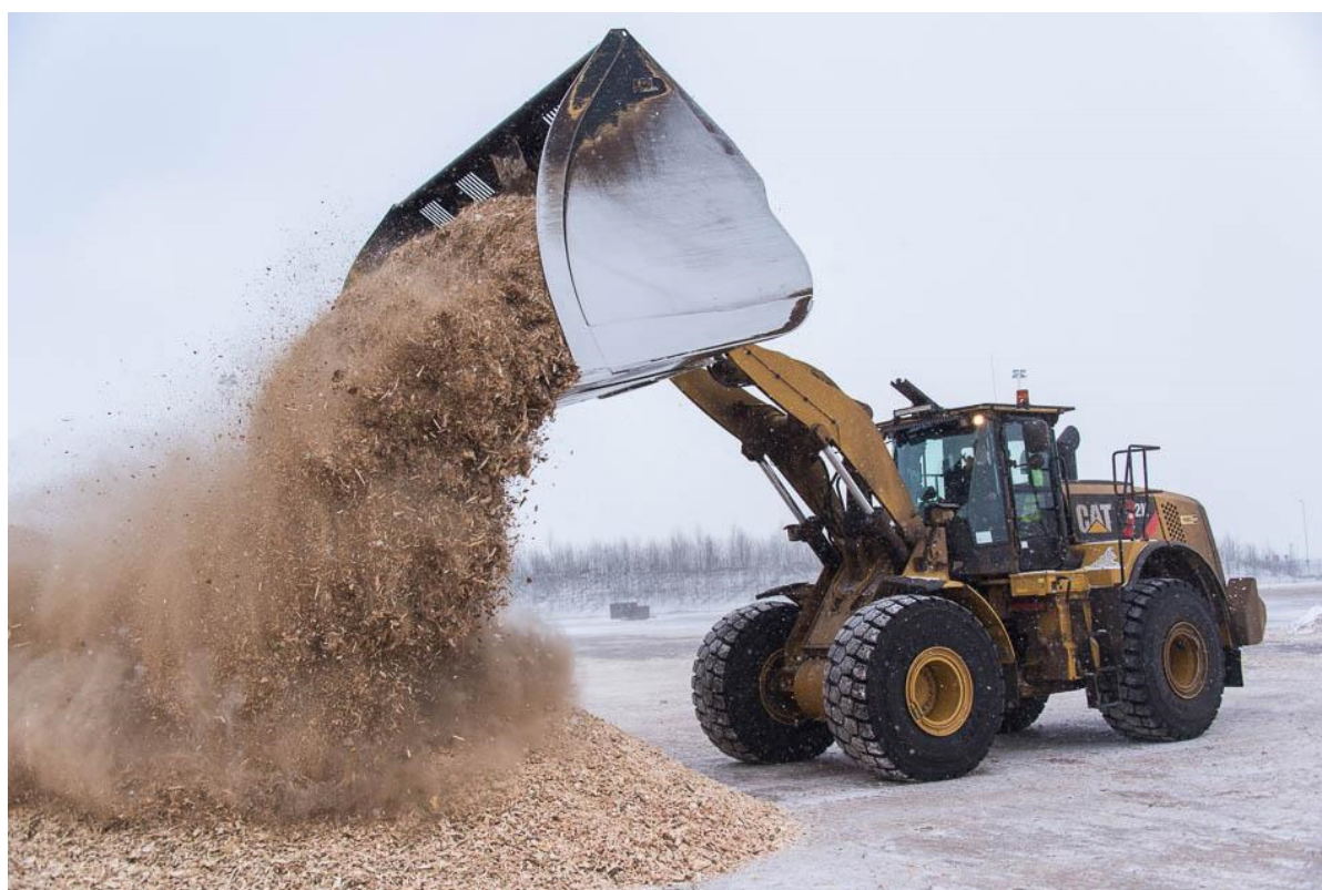
Figur B2. Hjullastaren lastar en recepthög med de olika bränslena som den hämtat ifrån bränslehögarna. I denna bild tippas en skopa RT-flis ut. Den tidigare skopan med grot kan skymtas under.
