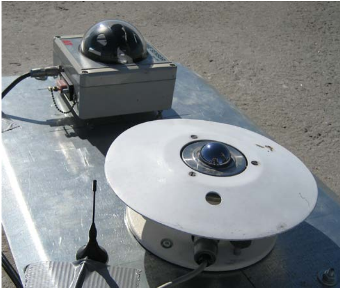
Figur 5.2. Stålningsmätare på toppen av betongbågen
