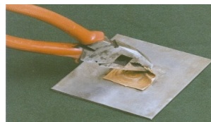
Fig. 10. Peel off test
