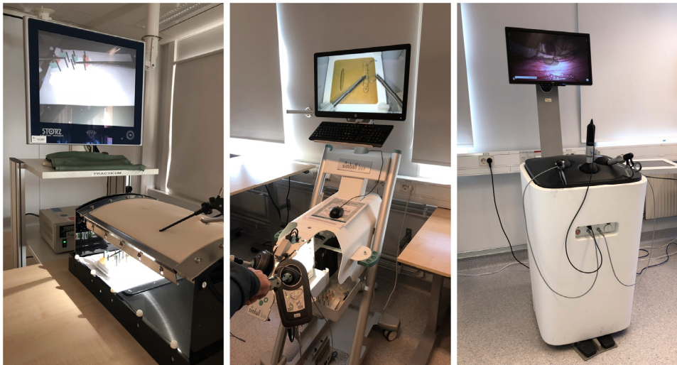
Figur 10. Tre vanliga simulatorer. Vä, vanlig video boxtränare där inga mätvärden erhålles. Mitten, Simball® Box, där vanliga instrument används och man får mätvärden. Hö: Virtual Reality simulator, LapSim® Haptic, där instrumenten är joysticks och man får mätvärden. I VR kan man träna hela procedurer. Photo by KH 2018
