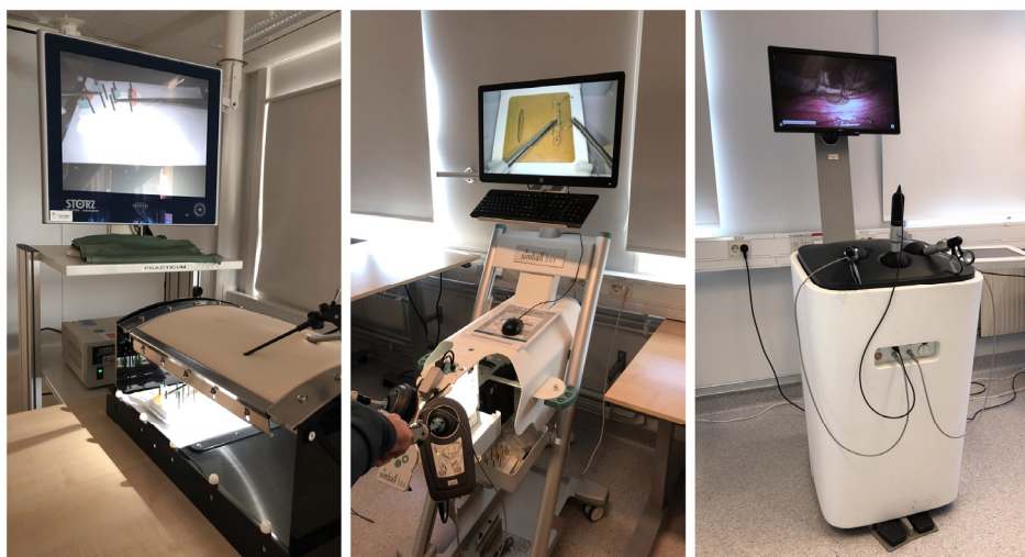
Figur 11. Tre vanlige simulatorer. V; vanlig video boxtrener der man ikke får ut måleverdier på bevegelsesmønstret. Midten, Simball Box, der vanlige instrument brukes og man får ut måleverdier. H; Virtual Reality simulator, LapSim Haptic, der instrumenten er joysticks og man får ut måleverdier. I VR kan man trene hele prosedyrer. Photo by KH 2018
