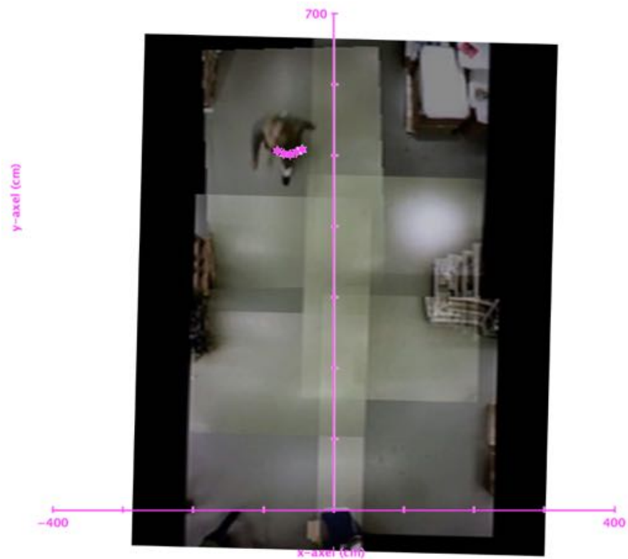
Figur 5.4 Exempel på data från laserskannern när en försöksperson går framför pelaren
