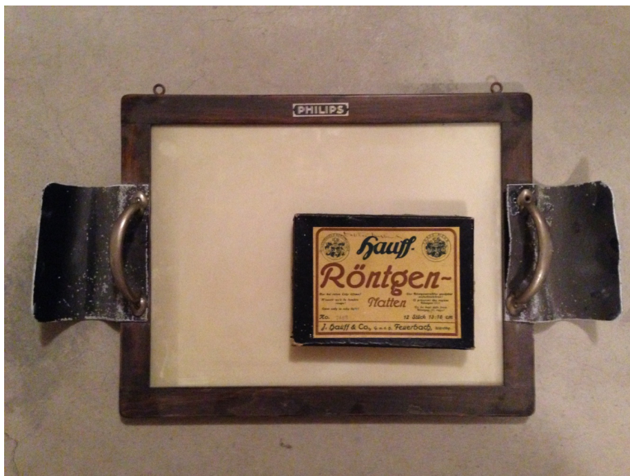
Figur 2. Vid en genomgång av fysikinstitutionens källarutrymmen återfanns utrustning demonstration av röntgenstrålning. Handtagen är skyddade med plåtar av bly.
