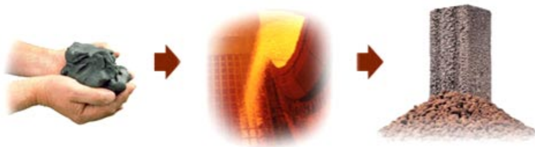
Bild 2.8. Lättklinkerkulor tillverkas av lera i roterande ugn.
