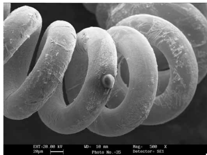
En fastbränd glaspartikel på glödtråden vittnar om att lampan var tänd då den krossades. Bilden är tagen med ett svepelektronmikroskop.
