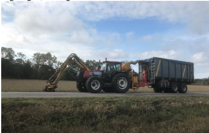
Figur 1. Traktordragen slagslåtteraggreat (Herder) för avslagning och uppsamling av vägkantsvegetation på Öland. Foto: Sven-Erik Svensson.
