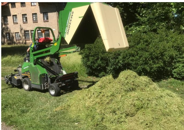
Figur 4. Mindre slagslåttergräsklippare med uppsamlingsfunktion för vegetationen (Amazone 4WD Profihopper). Foto: Sven-Erik Svensson.
