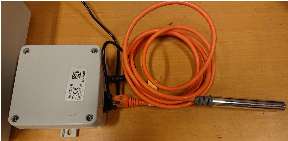
Figur 3.3 Sensohives fuktsensor inklusive kabel från sensor till plastbox och elnätsladd.
