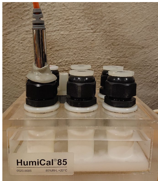
Figur 3.7 Sensohive fuktsensor monterad i kalibreringsblock, HumiCal®85 från Humi-Guard®.
