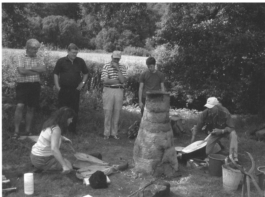
Fig. 3. Den dominerande typen av reduktionsugn i norra Skåne var under medeltiden schaktugnen. På bilden syns en rekonstruerad ugn som byggdes vid Hovdala 2005. Ugnen beskickades med träkol, sjömalms och kalk enligt ett beskicknings-schema man använt i Lejre Forsøgcenter på Själland. Försöket var en publikmässigt succé men ett produktionsmässigt fiasko. Foto: Anders Ödman.
