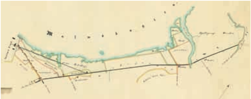
Bild 101. Bilderna tillhör en av fyra skisser på den projekterade chaussén mellan Malmö och Hurva. Notera att träden skall planteras mellan väg och dike för att inte inkräkta på åkermarken. Källa: Beijer 1847.
