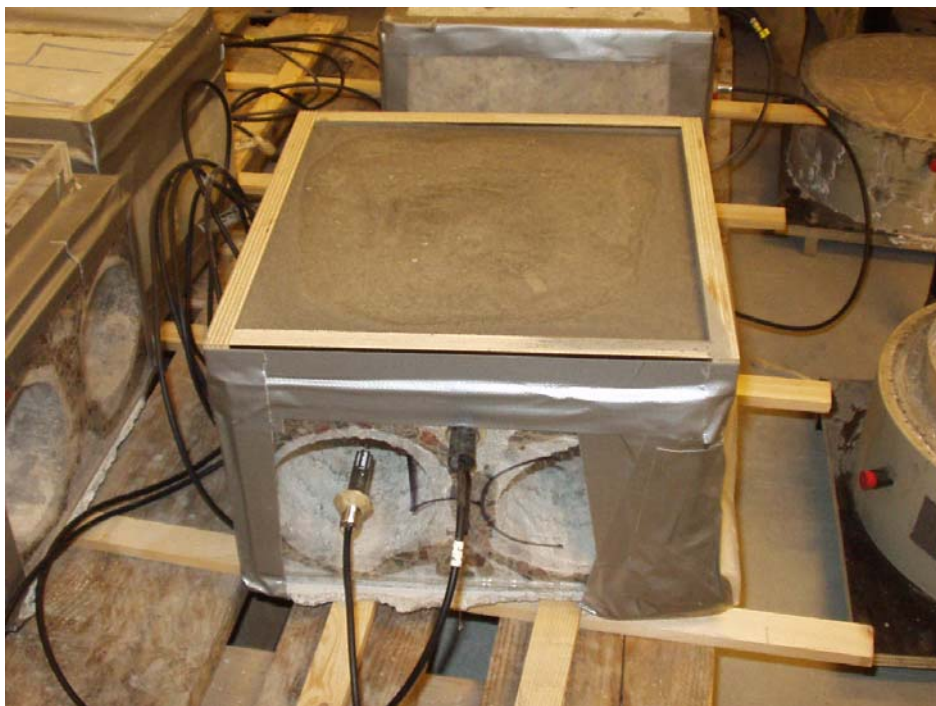
Figur 8.7 Placering av RF-givare i HD/F-bjälklag.
