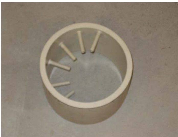
Figur 3.2 Kvarsittande form med monterade mätrör.
