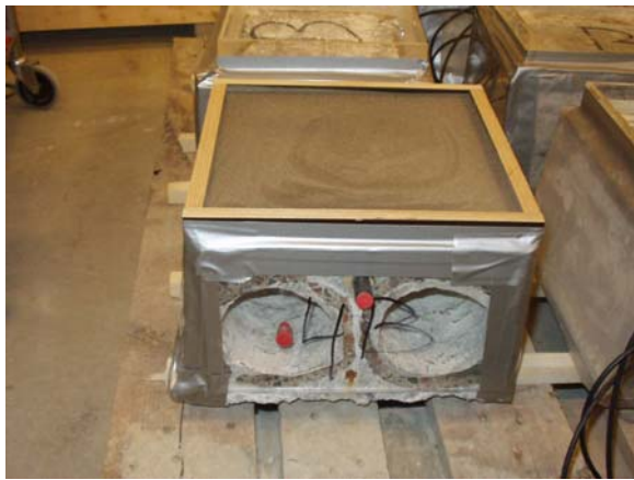
Figur 8.2 Provkropp av HD/F med plexiglasskivor och mätrör för RF-mätning.
