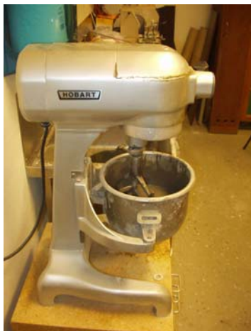
Figur 4.1 Hobart-blandare för tillverkning av cementbruk.
