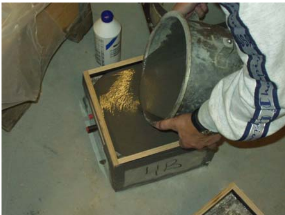
Figur 8.6 Avjämning av provkroppar.
