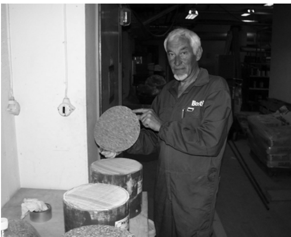
Figur 3.2 . Mattan vättes först genom att läggas på och dras av en gång från ytan på provkroppen.
