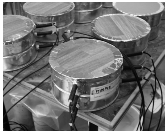
Figur 3.6 - Mätningen utfördes under 2 dygn eller till dess RF stabiliserats (normalt 1 dygn).
