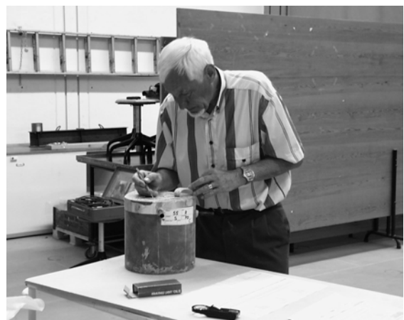
Figur 3.11 - Bedömning för att fastställa på vilket sätt fläkningsbrottet hade skett.
