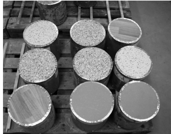
Figur 3.3 - Limmade mattor med en adhesiv aluminiumtejp runt provkroppens kant.
